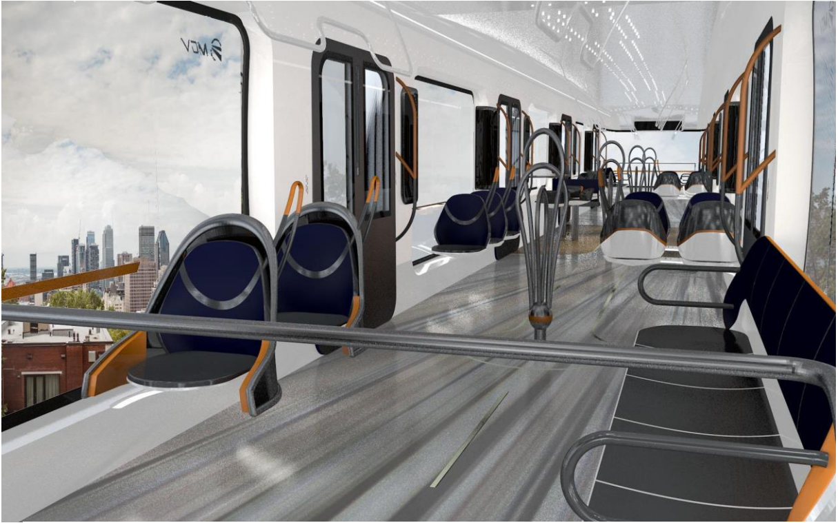
Figure 6: Intérieur d'une navette de monorail urbain intégrant le concept des appuie-mains de type "Fouet"
